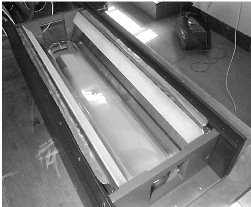
Figura 7.1: Imagen real del resonador del láser TEA-CO 2 en construcción, con los electrodos de alta compactificación.
